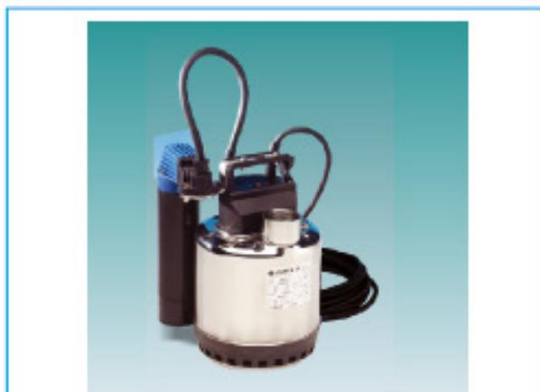
Esta chave de bôia permite a instalação da bomba onde a utilização da bôia padrão não é possível devido ao espaço disponível. A bomba com este sistema deve ser instalada somente na vertical e utilizada apenas com água limpa. Os níveis de partida e parada da bomba com este sistema são fixos não podendo, portanto, ser modificados.
